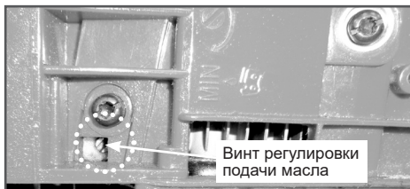
Рис. 11 Расположение регулировочного винта подачи масла
