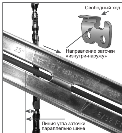
Рис. 28 Определение угла заточки
