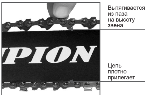
Рис. 5 Регулировка натяжения цепи
