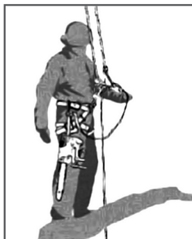
Рис. 19 Пример крепления пилы к ремню оператора
