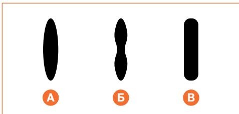
Для достижения формы пятна «В», отрегулировать подачу ЛКМ винтом хода иглы, давление воздуха на входе в распылитель регулятором давления (не на всех моделях распылителей), поток воздуха в боковых: выступах крышки распыляющей головки. винтом-регулятором.
