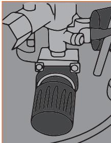
Для уменьшения давления, поворачивайте ручку против часовой стрелки, для увеличения давления поворачивайте ручку по часовой стрелке.
