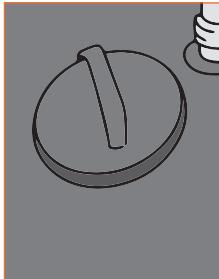
Пополнение бака может производиться через заправочную горловину в крышке бака после освобождения бака от воздуха (доступно не на всех моделях).
