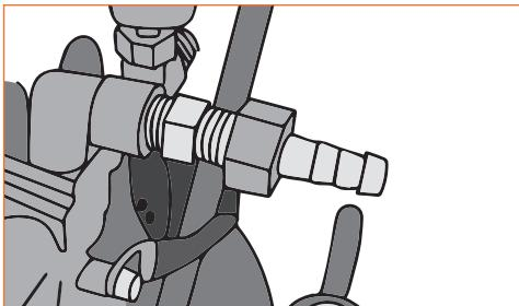
5. Соедините один конец шланга подачи сжатого воздуха к распылителю с баком, другой конец соедините с распылителем.
