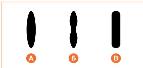
Для достижения формы пятна «В», отрегулировать подачу ЛКМ винтом хода иглы, давление воздуха на входе в распылитель регулятором давления (не на всех моделях распылителей), поток воздуха в боковых: выступях крышки распыляющей головки. винтом-регулятором.
