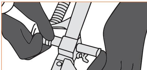
4. Установите верхнюю часть опорной трубы на нижнюю часть опорной трубы через зажим. Таким образом, чтобы крепление для икры было вверху.
