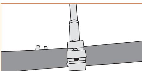
6. Установите опорную трубу таким образом, чтобы нога и основание ходулей были в одной прямой, и при работе на ходулях они стояли прямо (ровно), в одну линию. После данной регулировки крепко затянуть все болты.
