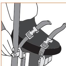
3. После завершения работ на ходулях сначала отсоедините ремни стопы, а только потом ремень для икры.
