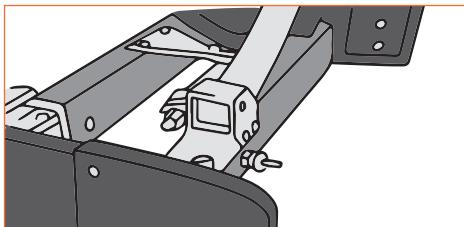
2. Прикрепите, не затягивая, нижнюю часть опорной трубы к нижнему креплению болтами 1/4 "x 1-3/4".
