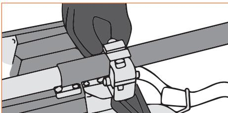
5. Равномерно затяните зажимы опорной трубы достаточно, чтобы предотвратить верхнюю часть опорной трубы от вращения при использовании. Не затягивайте зажим слишком сильно, опорная труба может быть деформирована (испорчена), и требовать замены.
