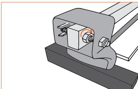
2. Установите направляющую так, чтобы резец проходил ровно по линии. Зафиксируйте расположение направляющей гайками.
