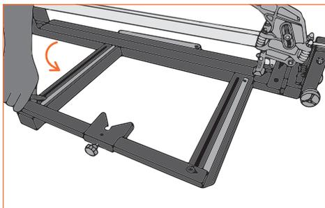
3. Закрепите положение линейки с помощью присосок.
