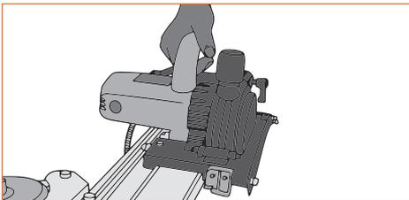
5. Подсоедините пылесос. Снимите защитную крышку и подключите шланг пылеотведения (не входит в комплект) к устройству.
