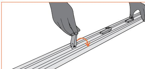
3. Снимите резиновый стопор с одной из сторон направляющей.
