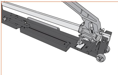
2. Для дополнительной фиксации используйте угол-линейку.
