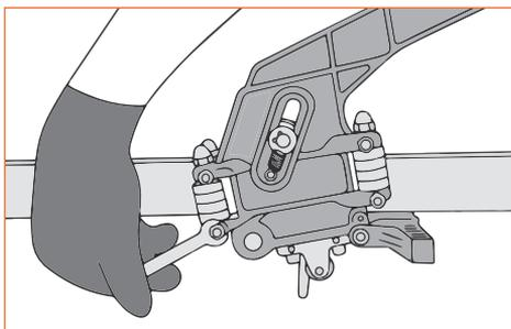
2. С помощью шестигранника отрегулируйте прижимную силу подшипников так, чтобы каретка перемещалась равномерно. Зафиксируйте защитные болты.
