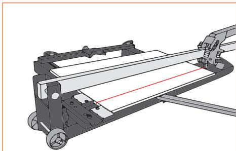
2. Включите лазер и проверьте правильность положения линии разреза.
