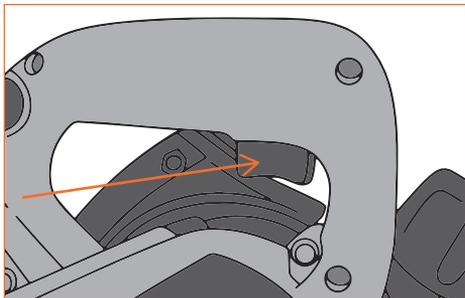
**3.** Чтобы зафиксировать положение кнопки нажмите на кнопку с боковой части ручки.
