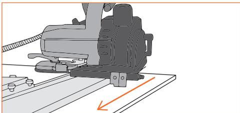
**5.** Для резки под углом 45 градусов, используйте специальный резчик, представляющий собой аналогичное устройство, но с наклонной установкой.
