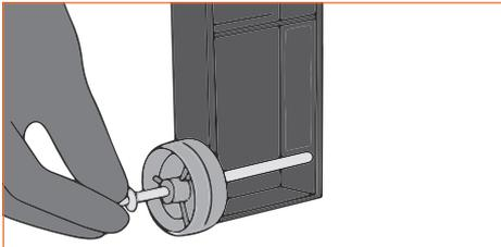
2. С другой стороны наденьте второе колесо, шайбу и закрепите гайкой.
