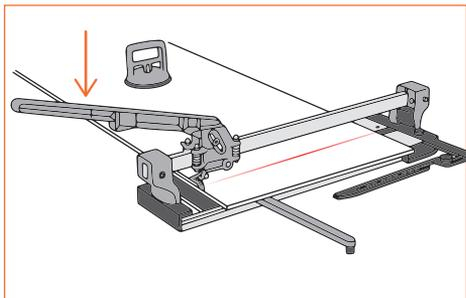
2. Проведите плавно каретку вдоль разметки в направлении от себя с небольшим нажимом. Допускается проводить роликом по поверхности плитки только один раз, в противном случае рез может получиться неровным.
