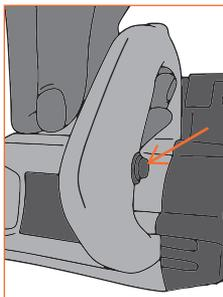
**4.** Проведите аппарат по разрезаемой плитке без усилия на рукоятку.
