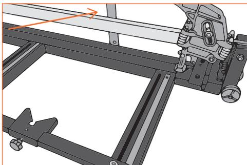
5. При диагональных разрезах для фиксирования плиты используйте угол-упор.
