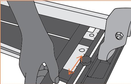
3. Установите необходимый угол. Для ровного среза установите угол  $90^\circ$ , а для диагональных  $45^\circ$ .
