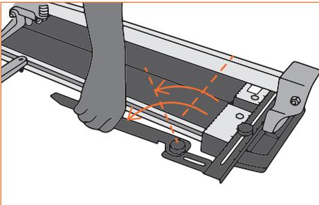
4. Зафиксируйте линейку-угольник.
