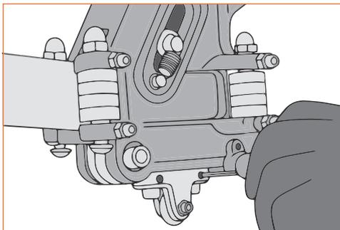
3. Зафиксируйте положение резца винтами.
