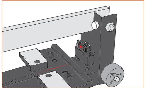
6. Зафиксируйте плитку на платформе так, чтобы размеченная линия реза совпала с траекторией перемещения каретки, на которой закреплен режущий ролик. На платформе имеется центровая метка, по которой удобно регулировать положение плитки.
