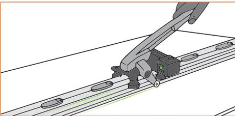
2. После завершения резки демонтируйте инструмент с поверхности.
