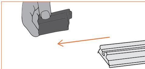
4. Установите режущую каретку на направляющую. Проследите, чтобы резец был с нужной стороны.
