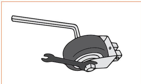
4. Собранные два роликовых кронштейна крепятся на пластиковые ножки, как показано на рисунке, а затем используйте шестигранную головку M5\*40 винты, контргайки M5, гаечный и шестигранный ключ для фиксации ролика в сборе на пластиковых ножках.
