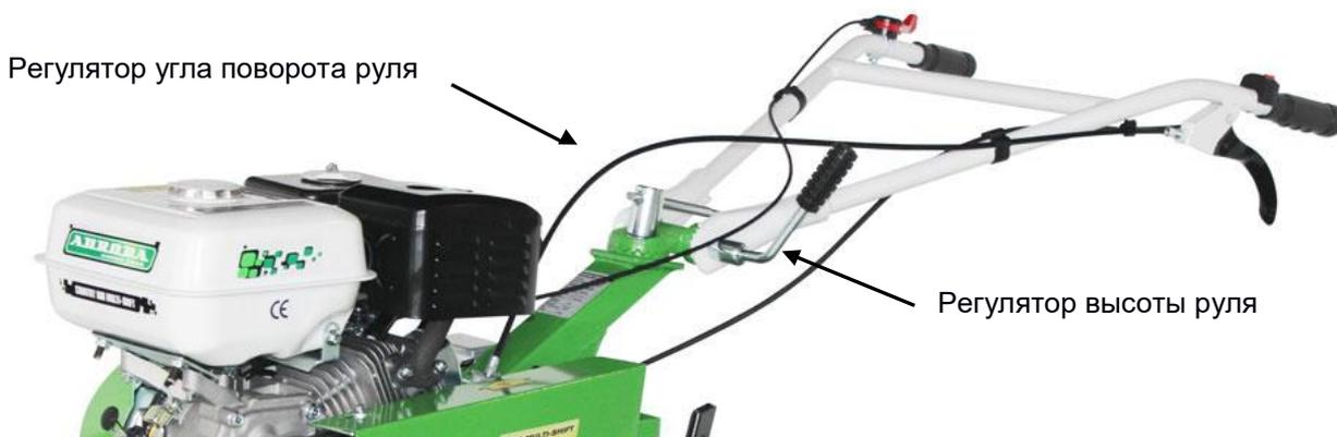
Для того чтобы отрегулировать высоту, отпустите ручку, выберите соответствующие разъемы и затяните регулятор. Обычно, рекомендуется высота на уровне талии.
