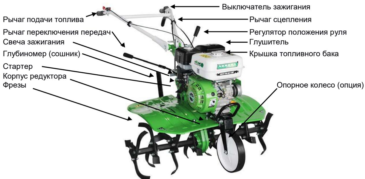
Вид мотоблока с установленными колёсами:
