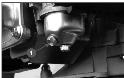
Рис. 20. Слив топлива с поплавковой камеры карбюратора
