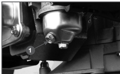
Рис. 22 Слив топлива с поплавковой камеры карбюратора
