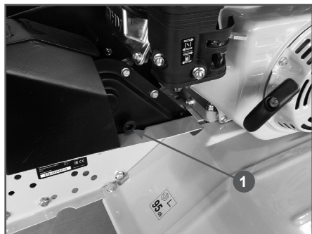
Рис. 24 Расположение пробки отверстия для добавления смазки в редуктор 1. Пробка
