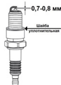
Рис. 23 Обслуживание свечи зажигания
