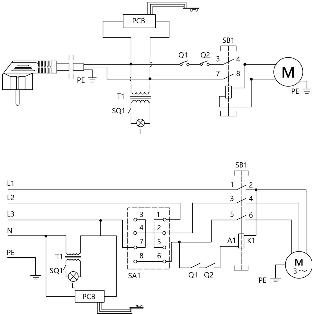
**Рисунок 20.** Электрическая схема для модели BELMASH DP430-16FVS/380
