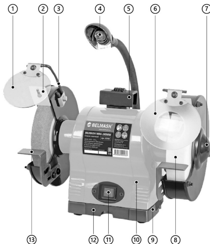
Рисунок 2. Основные элементы станка заточного BELMASH MBG-200MW
