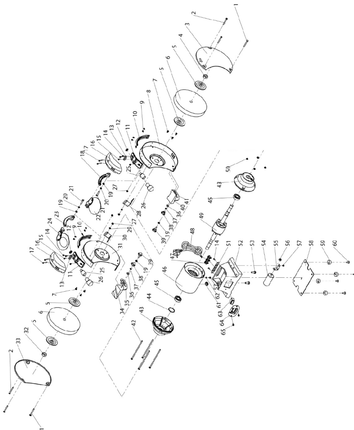
Рисунок 13. Взрыв-схема для модели BELMASH MBG-200M
