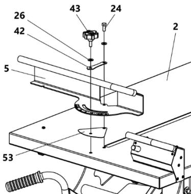
**Рисунок 6** Установка упора
