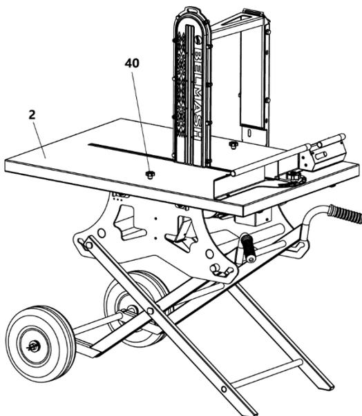
**Рисунок 13** Общий вид станка в транспортном положении
