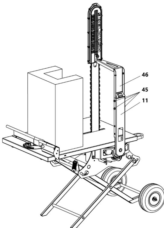
**Рисунок 10** Общий вид станка с вырезанным U-блоков
