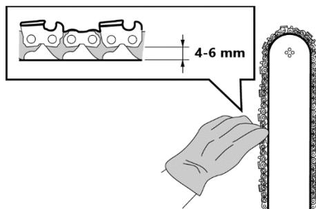
Рисунок 11 Проверка натяжения цепи
