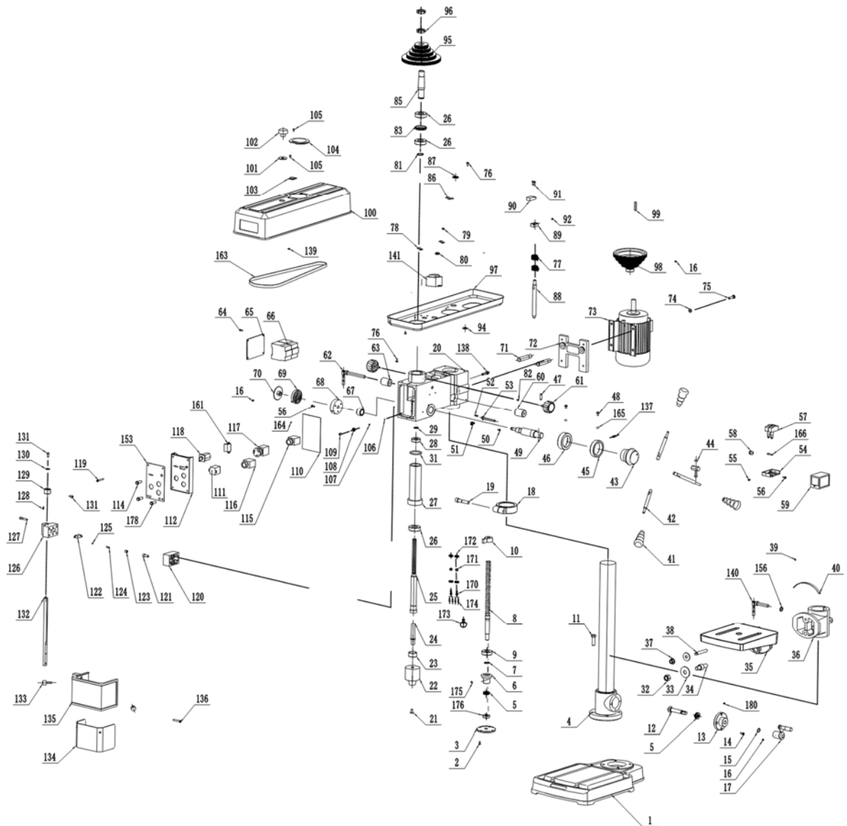
Рисунок 18. Взрыв-схема для модели BELMASH MDTP410-16/400
