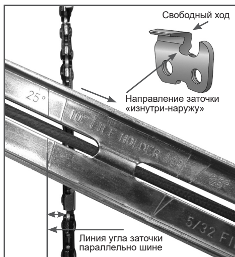
Рис. 22 Расположение линии угла заточки
