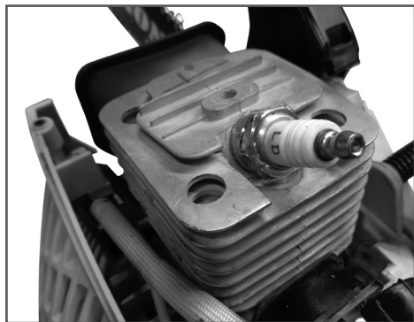
Рис. 28 Охлаждающие ребра цилиндра
