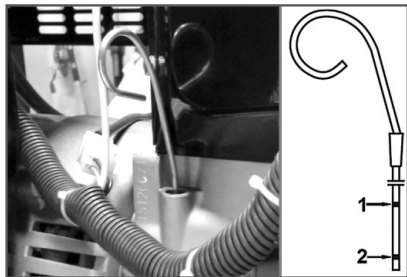
Рис. 8 Проверка уровня масла в картере
