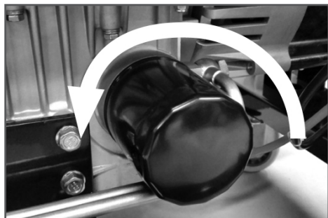
Рис. 15 Замена масляного фильтра
