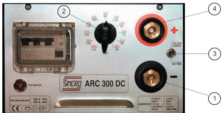
Примечание 1: Генератор агрегата защищён от перегрева при длительной сварке большим сварочным током посредством теплового реле-предохранителя на обмотке статора и теплового реле-предохранителя на выпрямительном мосту. «Сварочная» часть генератора при перегреве отключается и после оставания в течение нескольких минут включается автоматически.
