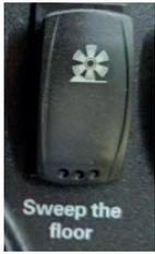
При нажатии на тумблер функции подметания вакуумный насос, двигатели боковых щетки и двигатель основной щетки включатся одновременно. (Боковые щетки опустятся автоматически)
