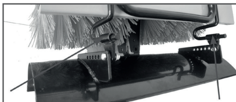
Рис. 5 Установка отвала на кронштейны щетки
