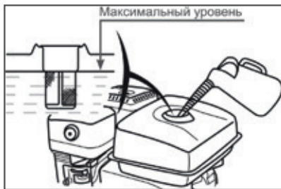
Рис. 16 Максимальный уровень топлива МОТОРНОЕ МАСЛО
