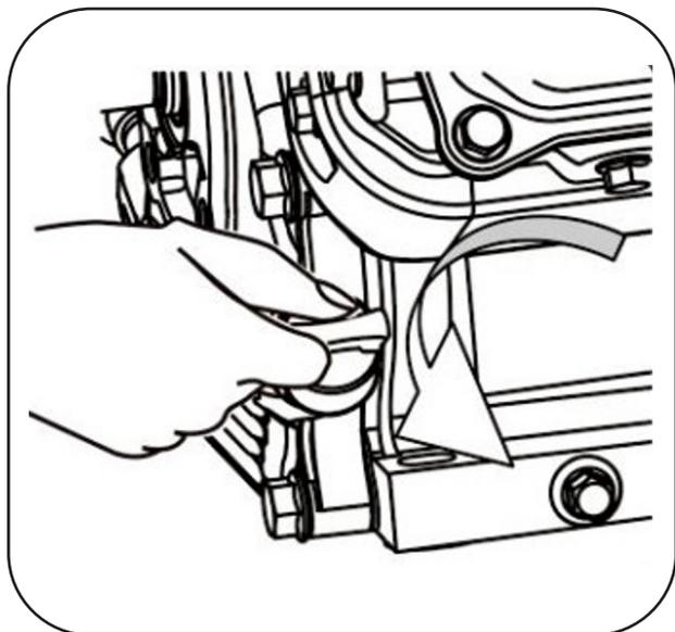
Рисунок 2. Проверка уровня моторного масла.
