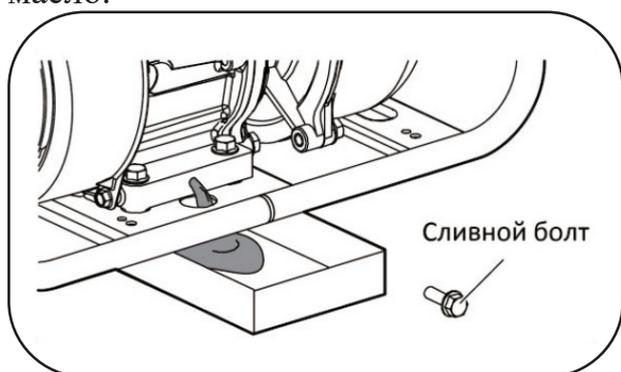
5. Закрутите сливной болт в картер.
