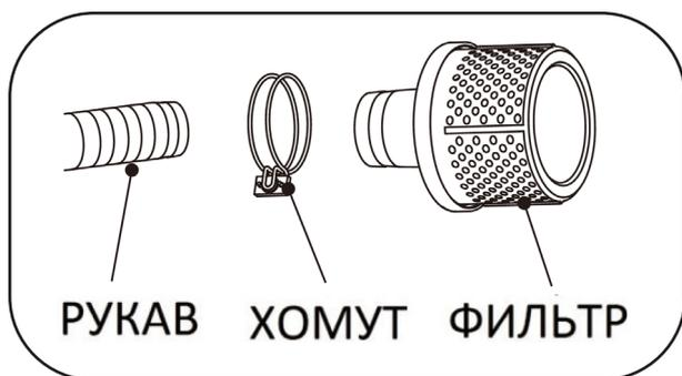
Подключение фитингов к всасывающему патрубку насосной части осуществляется в следующем порядке:
