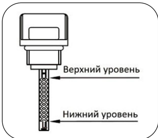
Рисунок 3. Отметки на масляном щупе.
