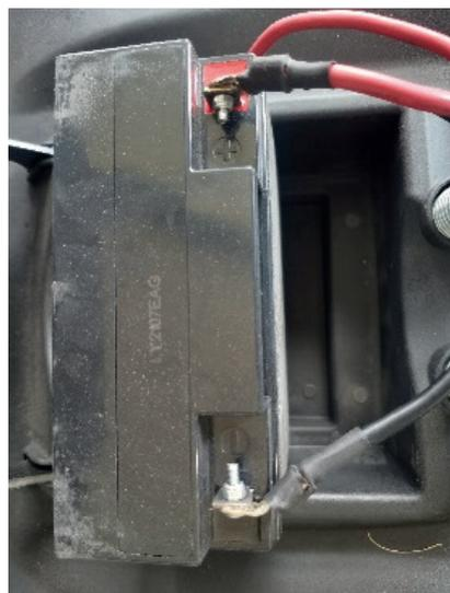
1. Установите аккумулятор вертикально в батарейный отсек под сиденьем.
