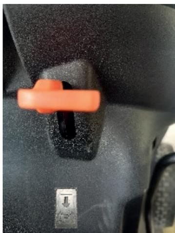
Этот рычаг останавливает движение машины, когда она припаркована.
