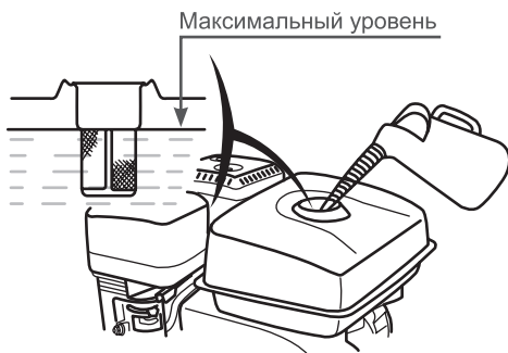
Рис. 8 Максимальный уровень топлива в топливном баке
