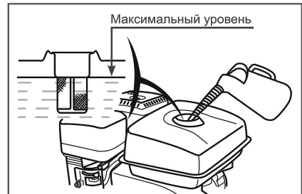
Рис. 6 Максимальный уровень топлива в топливном баке
