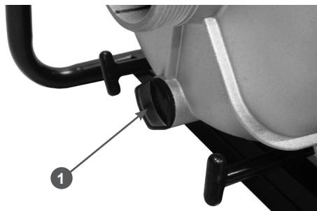
Рис. 18 Расположение пробки отверстия для слива воды из корпуса насоса
