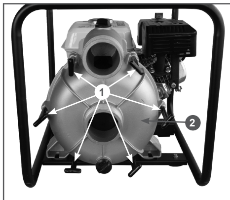
Рис. 23 Обслуживание водяного насоса
