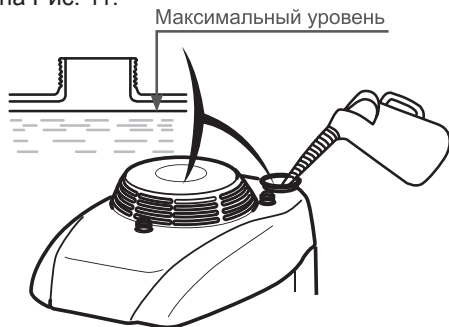
Рис. 11 Максимальный уровень топлива в топливном баке
