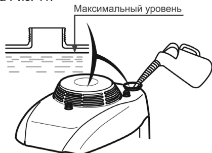
Рис. 11 Максимальный уровень топлива в топливном баке
