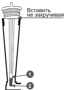
Рис. 16 Уровень масла в картере двигателя
