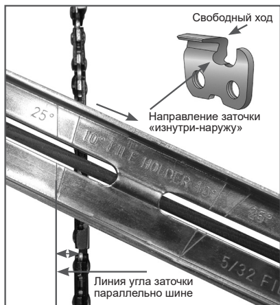
Рис. 27. Определение угла заточки
