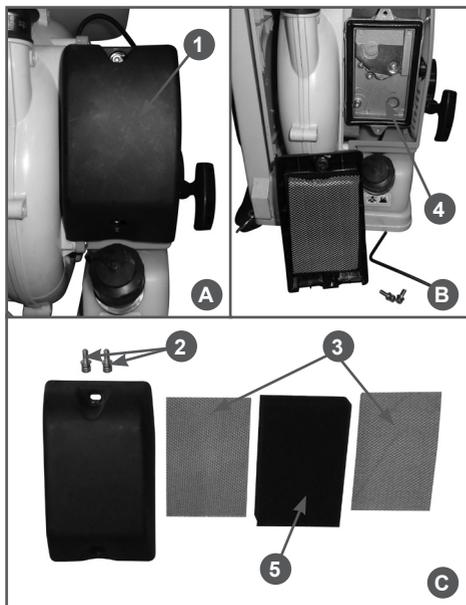
**Рис. 21 Обслуживание воздушного фильтра**
