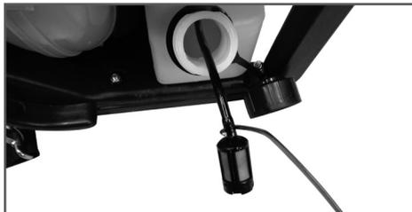
**Рис. 22 Извлечение топливного фильтра**
