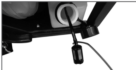
Рис. 22 Извлечение топливного фильтра
