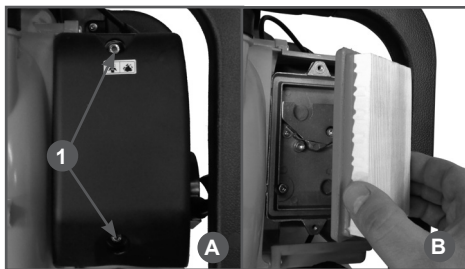
Рис. 21 Обслуживание воздушного фильтра
