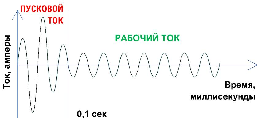
Пусковые токи необходимы для запуска, но несут с собой лишь негативные последствия, такие как перегрузка и перегрев электропроводки, прогорание плохо закрученных контактов, выход из строя электронных компонентов (конденсаторы, транзисторы, реле и др.).
